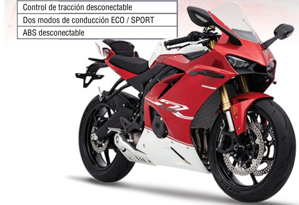
EQUIPADA CON UNA IMU QUE, JUNTO AL ABS Y EL CONTROL DE TRACCIÓN, DETECTA LA INCLINACIÓN EN CURVAS PARA AJUSTAR FRENADA Y POTENCIA, EVITANDO BLOQUEOS Y DERRAPES, Y OFRECIENDO MAYOR ESTABILIDAD Y CONTROL.
